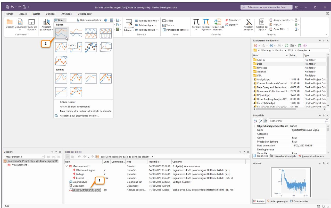
L'objet d'analyse nommé SpectreUltrasound Signal s'affiche dans la liste des objets [1]. Il représente l'analyse spectrale du signal ultrason et peut être utilisé comme un objet de données. Pour afficher ce spectre calculé dans un graphique, sélectionnez Insertion[Graphique] > Ligne > Lignes [2].
