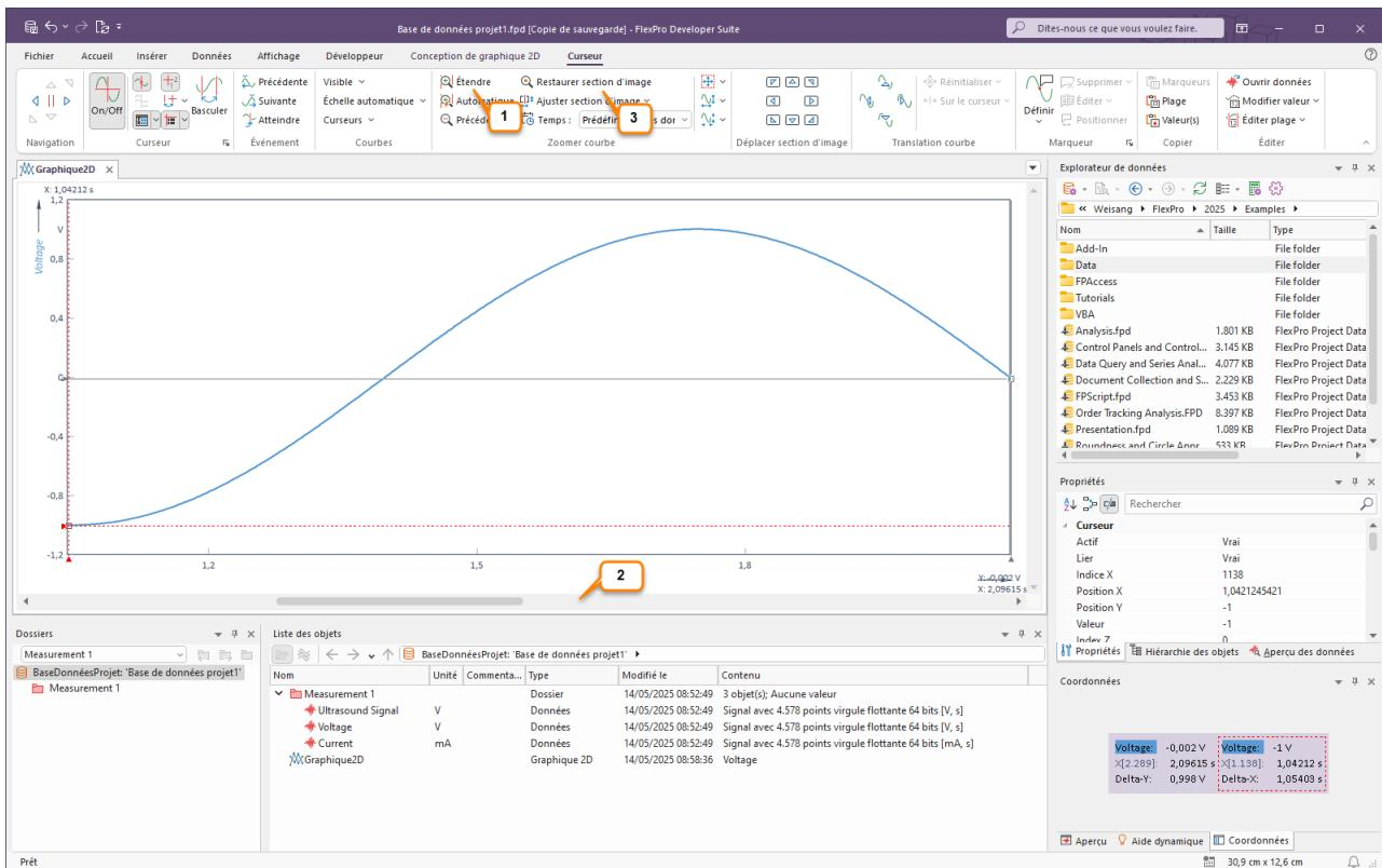
Cliquer sur l'icône Étirer [1] agrandit la section du signal entre les curseurs. Utilisez la barre de défilement [2] pour déplacer les données étirées dans le graphique.
