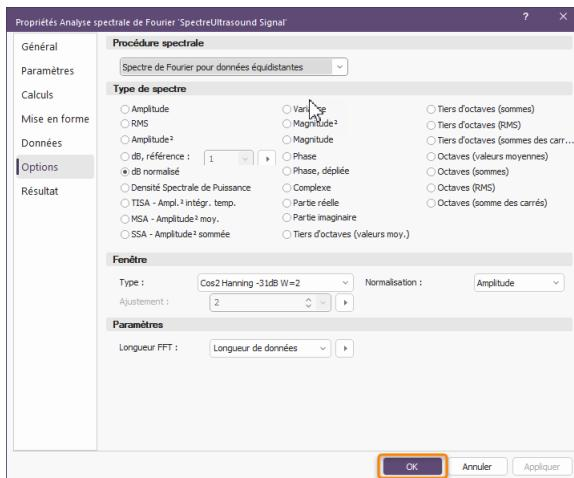
Dans la boîte de dialogue Propriétés qui est maintenant ouverte, laissez tous les paramètres inchangés et quittez en cliquant sur OK. L'analyse spectrale est effectuée pour cet exemple en utilisant les paramètres par défaut de la boîte de dialogue.
