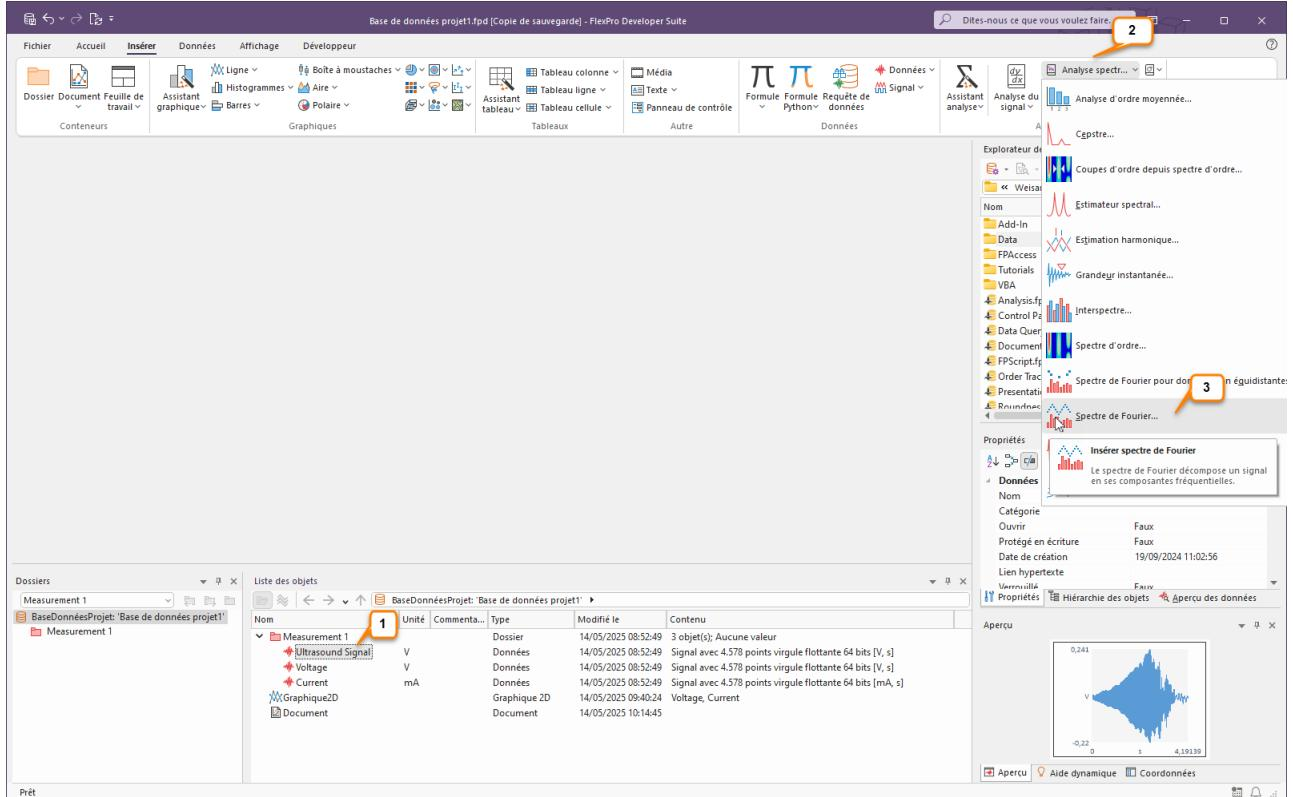
Dans la liste des objets, sélectionnez l'ensemble de données Ultrasound Signal [1]. Sélectionnez l'ensemble de données dans la liste des objets appelé Signal ultrasonore [1].
