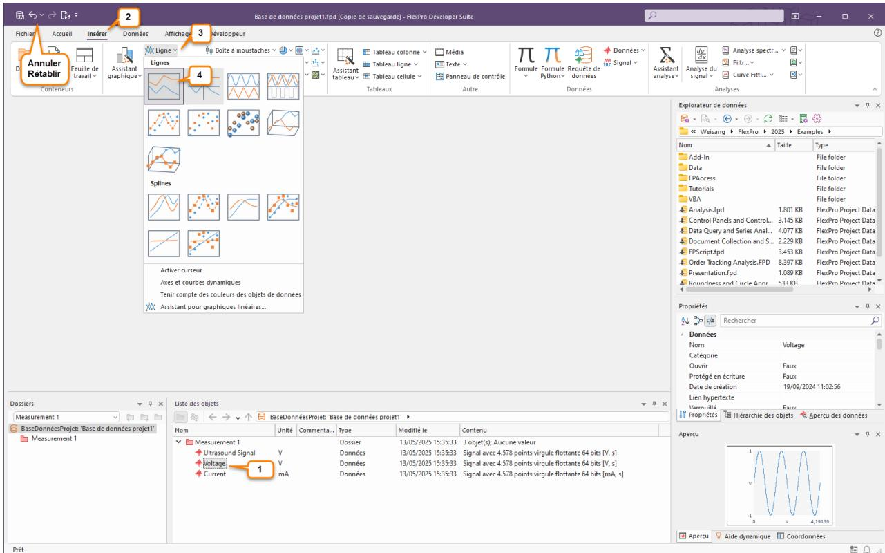
Dans la liste des objets, sélectionner l'objet de données Voltage [1] avec le bouton gauche de la souris. Ensuite, cliquez sur l'onglet Insérer du ruban [2]. Ouvrez le menu Ligne [3] et sélectionnez Lignes [4].
